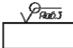
Рисунок 8.25. Обозначение одинаковой шероховатости поверхностей образующих замкнутый контур
