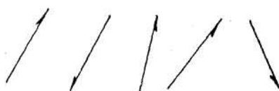
Рисунок 6.10. Обозначение одинаковых швов
