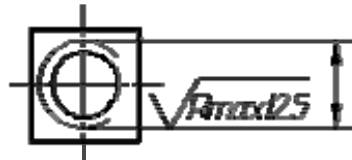
Рисунок 8.22. Пример обозначения шероховатости внутренней резьбы
