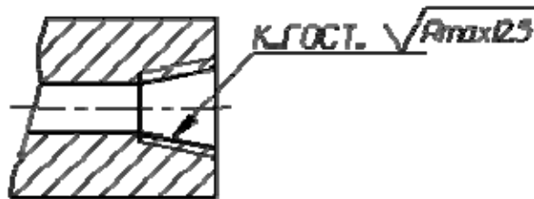
Рисунок 8.23. Пример обозначения шероховатости внутренней конической резьбы
